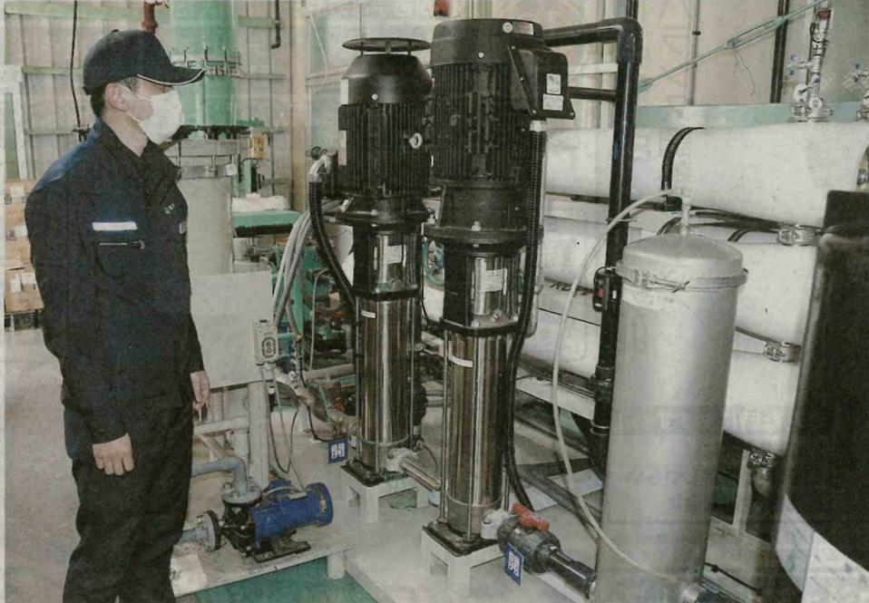
塚田理研工業が開発した、ニッケルのめっき液を再生する装置
