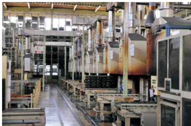
バッチ式浸炭炉ライン
