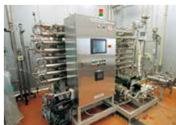
加熱・冷却型酵素失活装置
