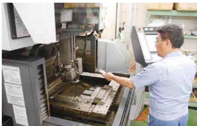
リニアモーター搭載のワイヤ放電加工機
