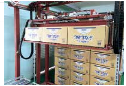
省力化を実現したダンボール積み上げ機
