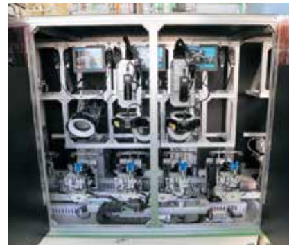
外観画像処理自動検査・搬送システム
