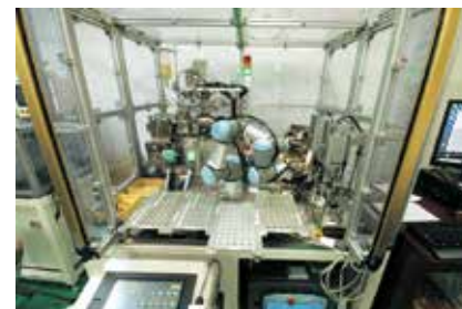
ドラム加工を自動化した専用機
