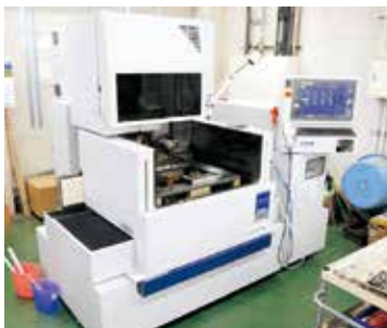
ものづくり補助金で導入したワイヤー放電加工機
