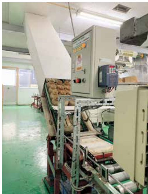
収穫済み搬送ライン（別棟次工程への搬送コンベア）
