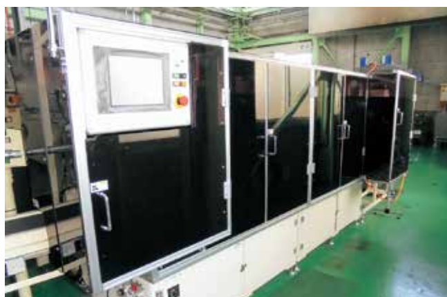
外観画像処理自動検査・搬送システム
