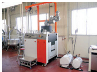
高圧処理装置
