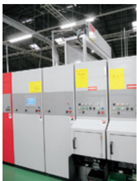
自動製函ラインに組み込まれた画像検査装置
