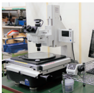
微細なプロセスを測定する測定顕微鏡
