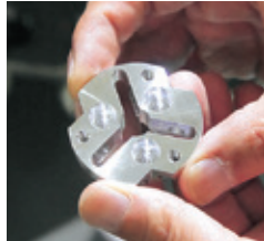
三次元精密機械加工技術を駆使して製造した部品
