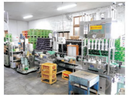
充填機（右）と小ビンに対応した打栓機のライン
