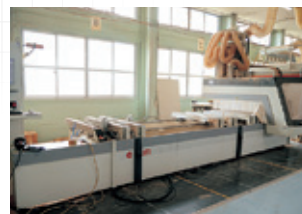
木製サッシ加工用5軸CNC加工機
