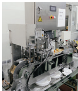
ロボット技術を駆使した「種抜き機」
