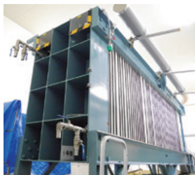
アルミ不使用の新しい上槽設備 （簀田式ろ過圧搾機）
