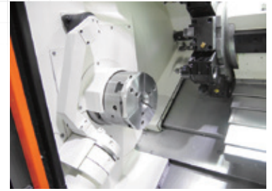
空気圧でやさしくくわえ歪みなく加工
