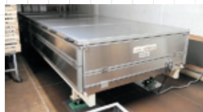
新型製麹機。 パネルヒーターで室内温度を上げる
