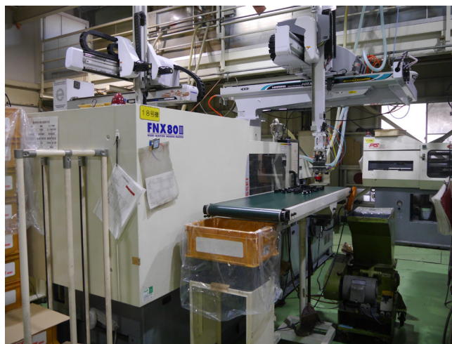
平成29年度ものづくり補助金で導入したハイブリッド射出成形機
