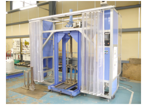
洗濯機の解体を補助する専用補助装置
