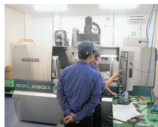
超精密成形平面研削盤（10nm制御）
