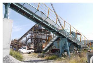
Hi・ウッズ・セパレーターを備えた高品質コンクリート骨材生産ライン（手前）
