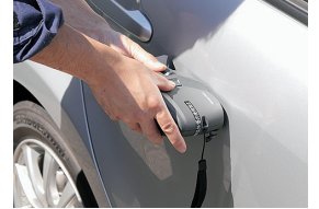
カメラでボディーカラーを測定
