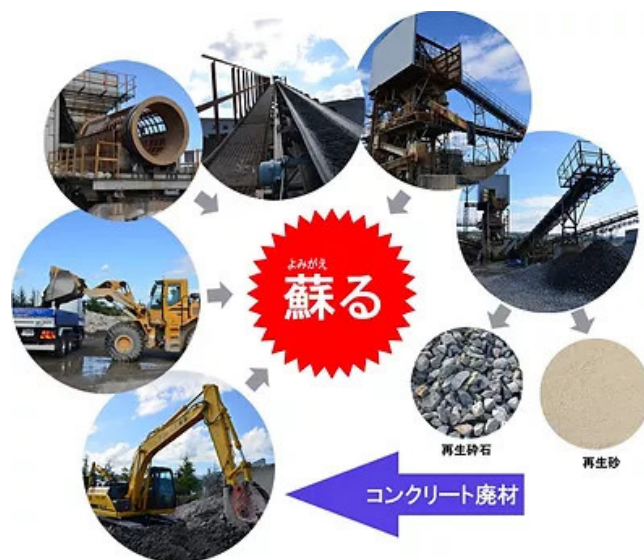
再生骨材製造プロセス
