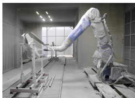
「ティーチングアシスト塗装ロボットシステム」による自動塗装
