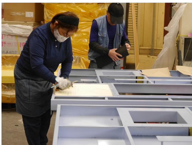
防音材の埋め込み
