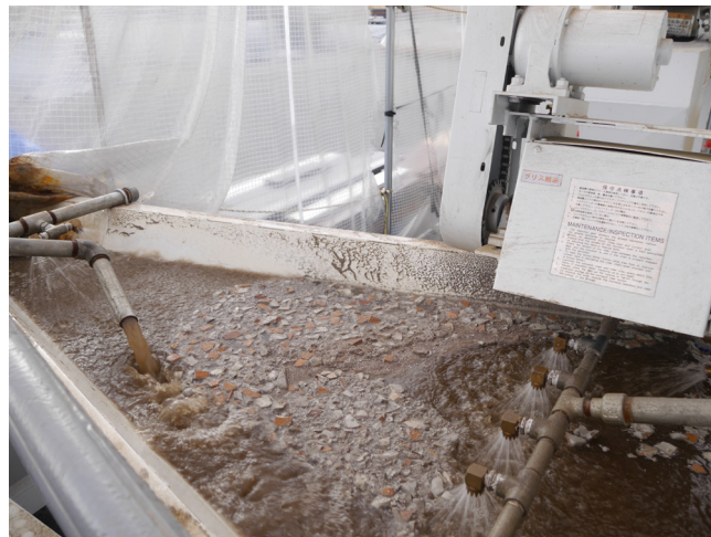
資源再生プラント_選別工程（水に浮いているのがウレタン、底にはアルミがたまる）
