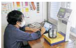
AIカラーシステム。パソコンと連動した精密スケールで塗料を調合
