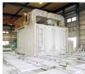
塗装工程に導入したガス式通過型乾燥炉
