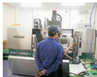
超精密成形平面研削盤（10nm制御）
