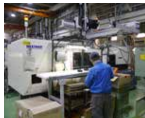
電気式高性能射出成形機と取り出し機
