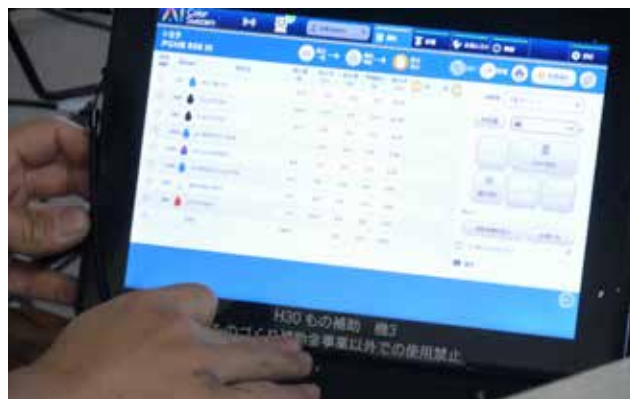
カラーナビ (カメラの測定結果で配合重量が決まる)
