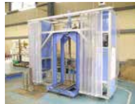
洗濯機の解体を補助する専用補助装置
