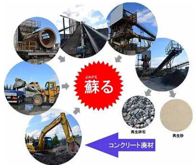
再生骨材製造プロセス
