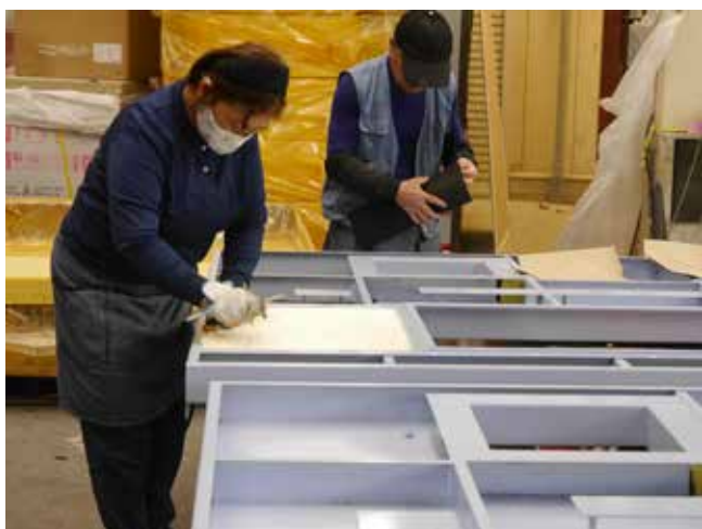
防音材の埋め込み
