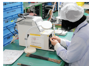
ケーブルの被覆をカットする高精度ストリッパー
