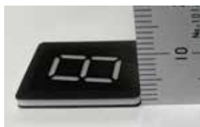
独自開発の薄型7セグメントディスプレイ（上 従来製品）
