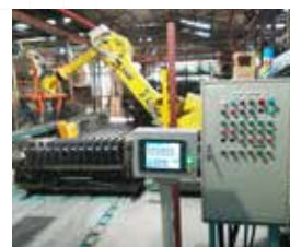
コンクリート蓋搬送ロボットシステム
