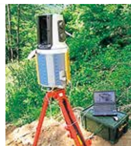
建設コンサルタント業務 （3Dレーザースキャナ測量）
