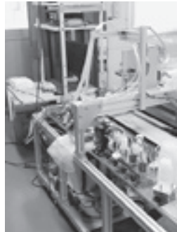
試作中の円筒形容器側面全面に直接印刷するプリンタ
