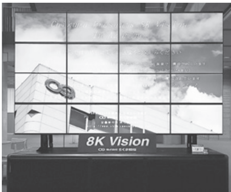
○8Kビジョン フルHDディスプレイ16枚で構成した 100インチ、3300万画素の液晶スクリーン
