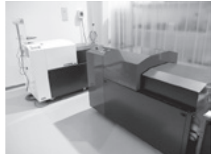
自社開発の工業用X線検査装置
