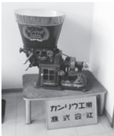
「大阪精米機製作所」時代の環流式精米機
