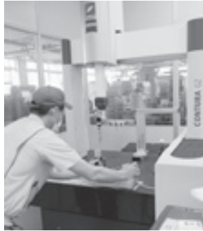
三次元測定機を導入し、カメラ部品の高精度加工に進出
