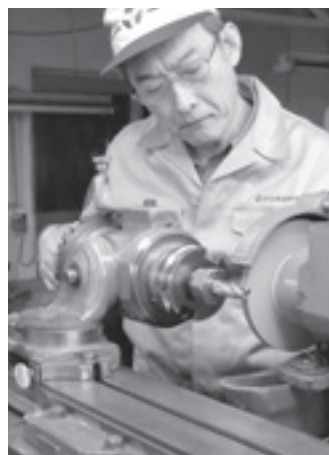
熟練技能者による切削工具の研磨
