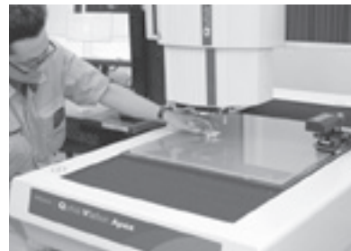
摩擦板開発のために導入した3次元測定機
