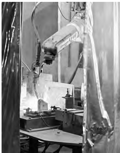
稼働するロボット溶接機
