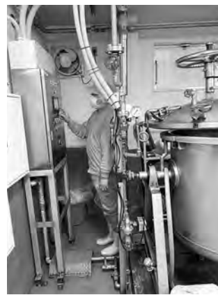
「簡易型蒸煮システム」で煮豆を自動制御
