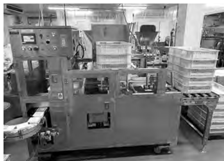
容器をコンテナに収納する「オートケーサー」
