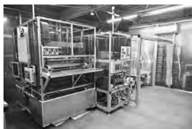
ロボットが作業を担う自動吊り段取り作業装置
