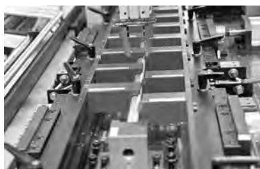
全自動で加工するバリシング機の内部機構
