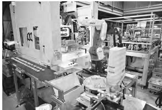
ロボットと堅型射出成形機を組み合わせた自社開発自動化設備
