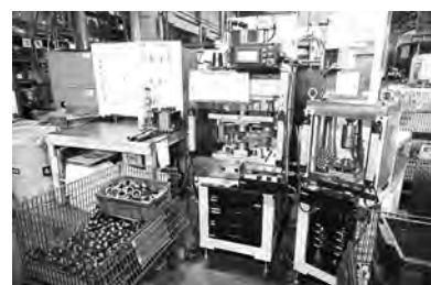
100トン(左)と3トンの端部プレス機
