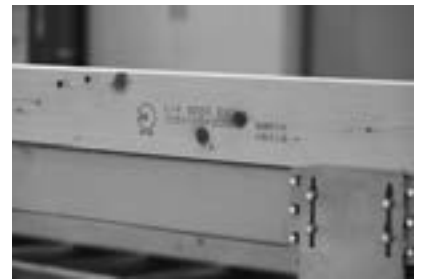
強度と含水率を測定・印字したJAS材
