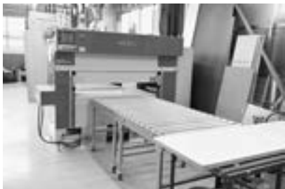
接着剤のみを加熱し高速接着する高周波接着機
