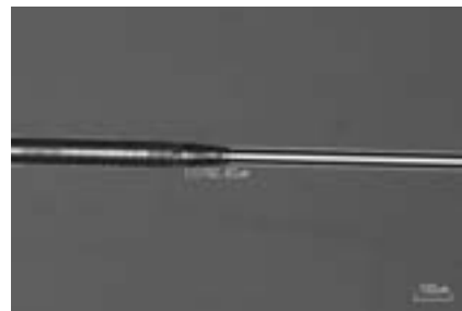
クラッドのみをナノレベルで細くしたエッチングファイバー
