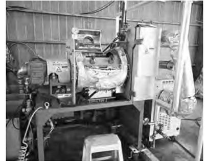
過熱蒸気乾燥機 (熱源：電気)
