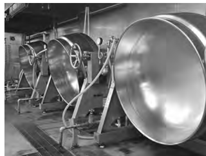
厨房設備回転釜
