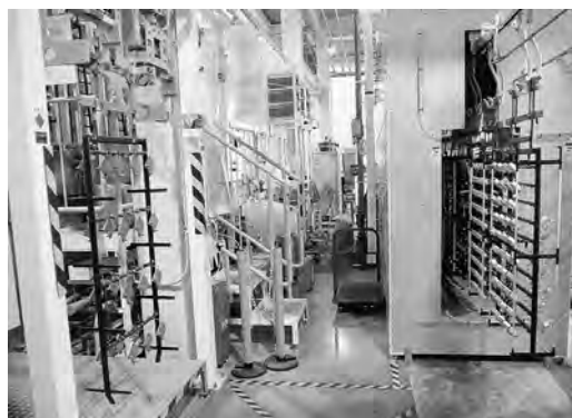
エアカッター（自動乾燥機）を導入しためっきライン
