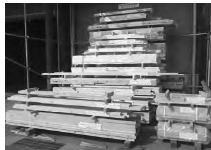
1棟ごとワンユニットで出荷するプレカット材
