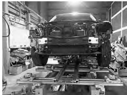
ボディアライメント計測器によるフレームの計測
