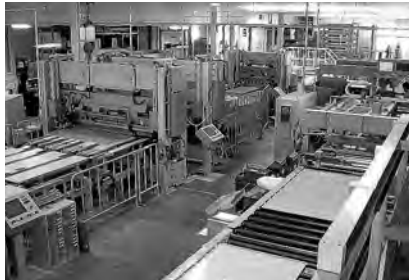
ユニットバスパネルの生産ライン
