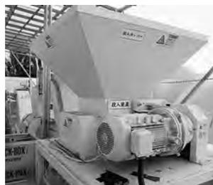
プラスチック複合材専用資源再生プラント 破砕機
