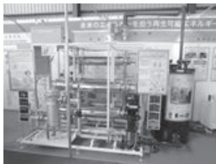
諏訪工業メッセ2018で披露された「膜浄水装置」
