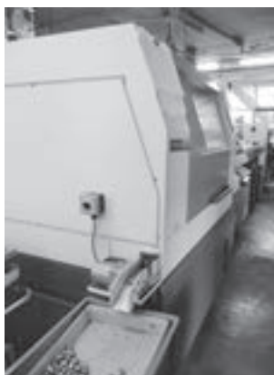
7軸タイプの最新鋭複合加工機
