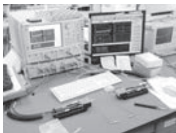
0.8mmコネクタの設計・検証を行うネットワークアナライザ
