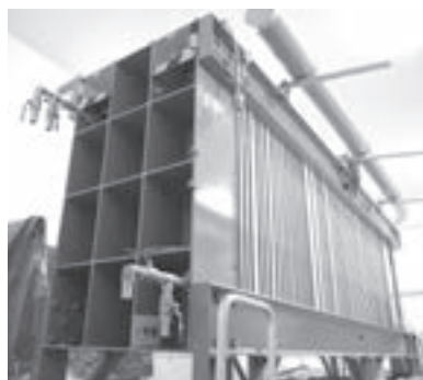
アルミ不使用の新しい上槽設備（藪田式ろ過圧搾機）
