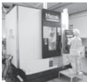
超音波ユニットを取り付けたマシニングセンター
