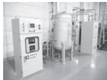
水素ガス・窒素ガス混合装置
