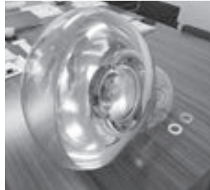
カミオカンデの光電子増倍管
