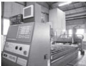
プラズマ切断機
