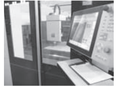
最新鋭のファイバーレーザー切断機
