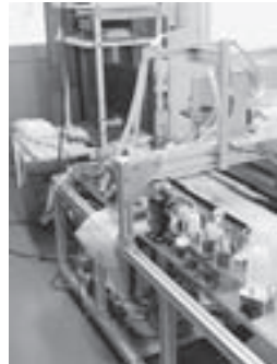
試作中の円筒形容器側面全周に直接印刷するプリンタ
