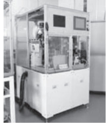
金属加工部品表面仕上げ（パフ研磨）自動化装置
