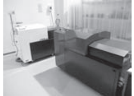
自社開発の工業用X線検査装置
