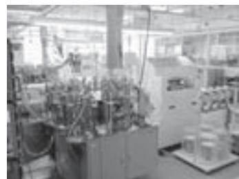
ものづくり補助金を活用して開発した車載モーター用ステーターの自動機
